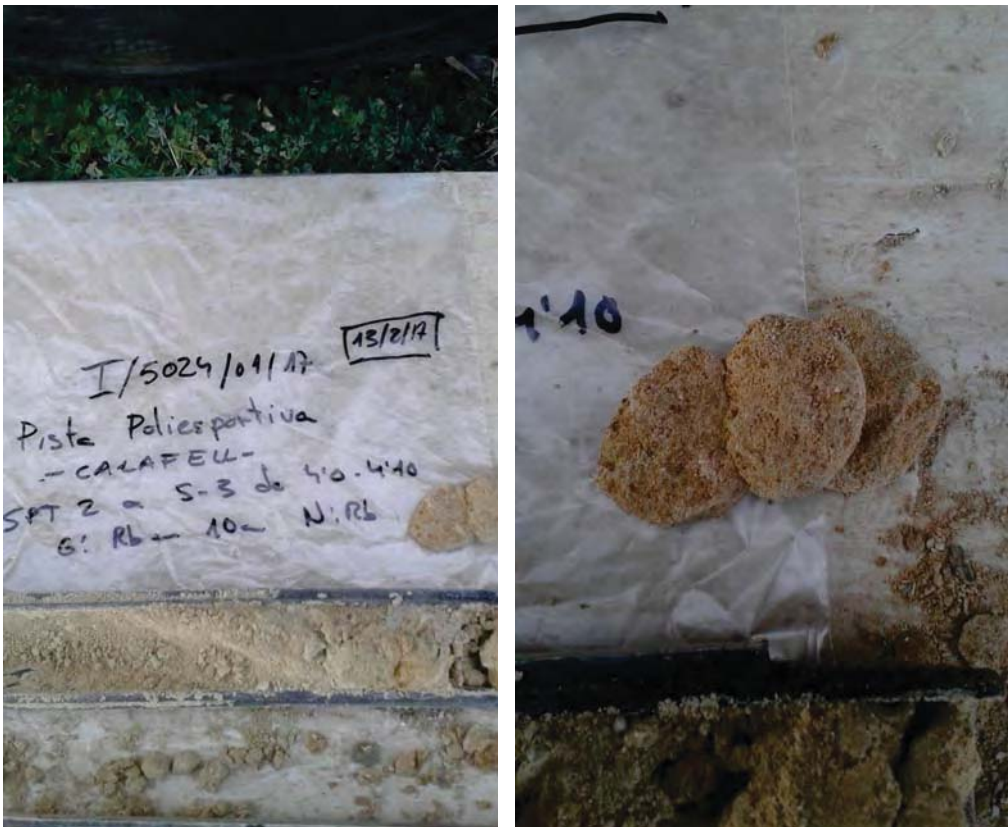
Vistes dels materials del subsòl extrets en dos assaigs SPT realitzats al llarg del sondeig S-3
