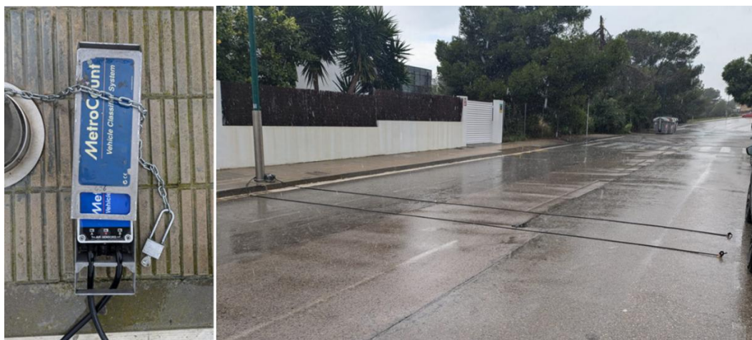
Màquina d'aforament automàtic pneumàtic col·locada al C. del Migjorn. Font: DOYMO
